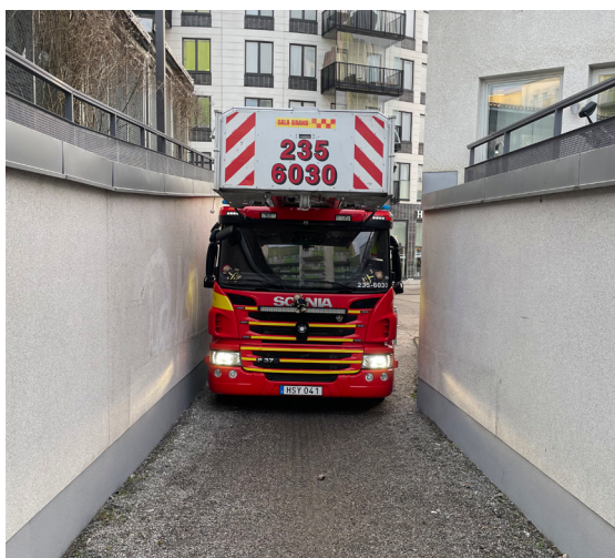
Figur 5 - Bild till vänster visar en räddningsväg som är projekterad enligt de minsta måtten. Bild till höger visar en räddningsväg som inte går att köra in på då svängradien är för kort från den kommunala gatan.
