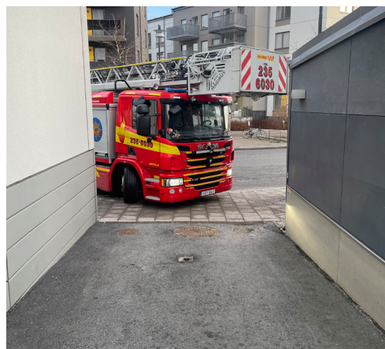
Figur 5 - Bild till vänster visar en räddningsväg som är projekterad enligt de minsta måtten. Bild till höger visar en räddningsväg som inte går att köra in på då svängradien är för kort från den kommunala gatan.
